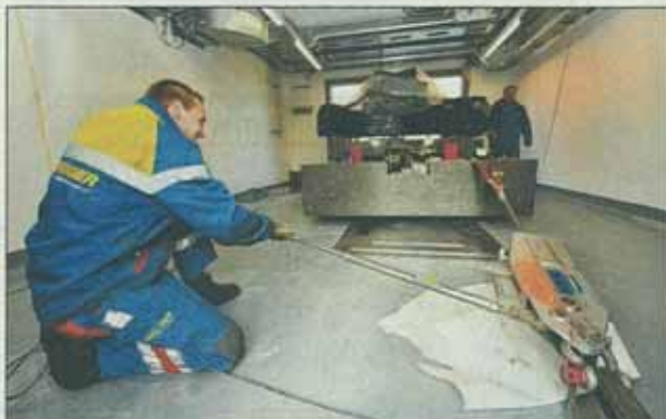
Bei der Empa wird ein Granittisch für eine Lasermaschine geliefert und installiert. Mittels Seilzug wird der Tisch ins Labor gezogen.
